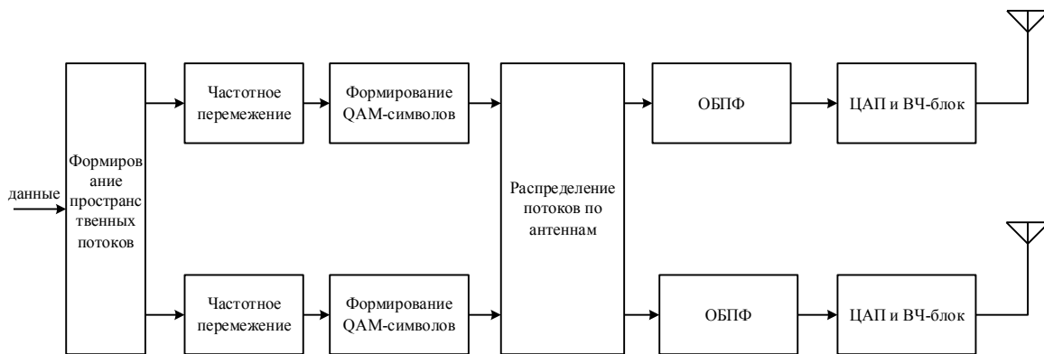
Рис. 4. Схема передатчика OFDM с использованием MIMO: ОБПФ-обратное быстрое преобразование Фурье; ЦАП и ВЧ-блок – цифро-аналоговый преобразователь и высокочастотный блок
