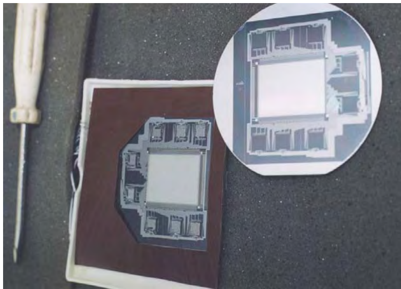
Рис. 2. Общий вид и конструкция ЖК ПВМС с разрешением 320×288 элементов отображения
