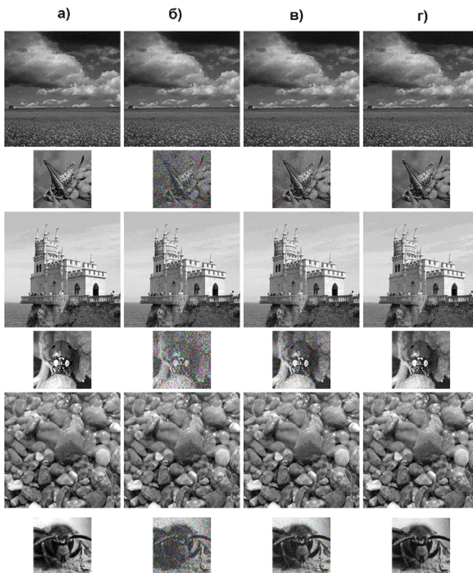
Рис. 4. a — исходные изображения-контейнеры и скрываемые изображения; б — стего-изображения и извлеченные скрытые изображения ( r = 2 ); в — стего-изображения и извлеченные скрытые изображения ( r = 3 ); г — стего-изображения и извлеченные скрытые изображения ( r = 4 )
