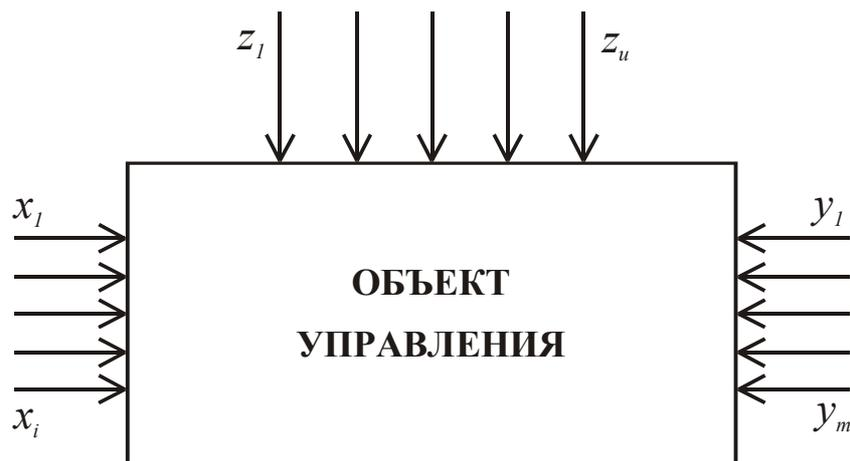
Рис. 2. Контролируемые параметры и возмущающие воздействия на объекте управления:  $x_1, \dots, x_i$  — входы объекта управления (контролируемые параметры);  $y_1, \dots, y_m$  — выходы объекта управления;  $z_1, \dots, z_u$  — возмущающие воздействия на объект управления
