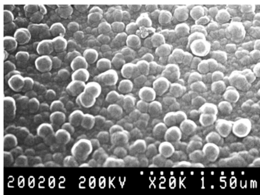
Рис. 5. Пленка поликристаллического кремния с полусферическими зернами
