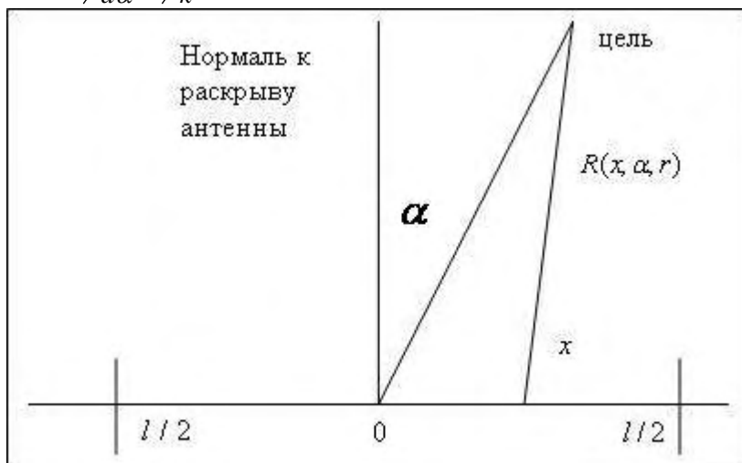
Рис. 1. Принцип определения расстояния до источника излучения по кривизне волнового фронта
