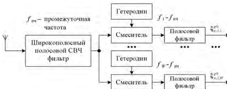
Рис. 1. Структурная схема многоканального приемного устройства
