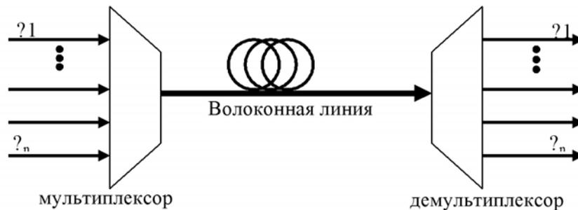
Рис. 2. Структура волоконно-оптической линии связи со спектральным мультиплексированием
