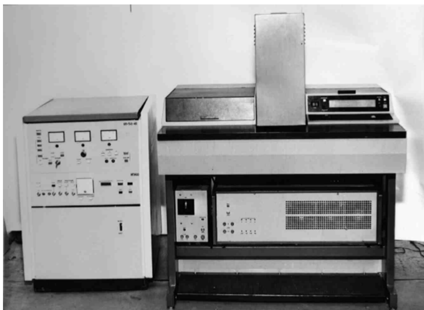
Рис. 4. Общий вид установки лазерного геттерирования кремниевых пластин
