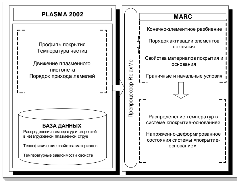
Рис. 3. Схема моделирования при помощи программных комплексов Plasma 2002 и MARC
