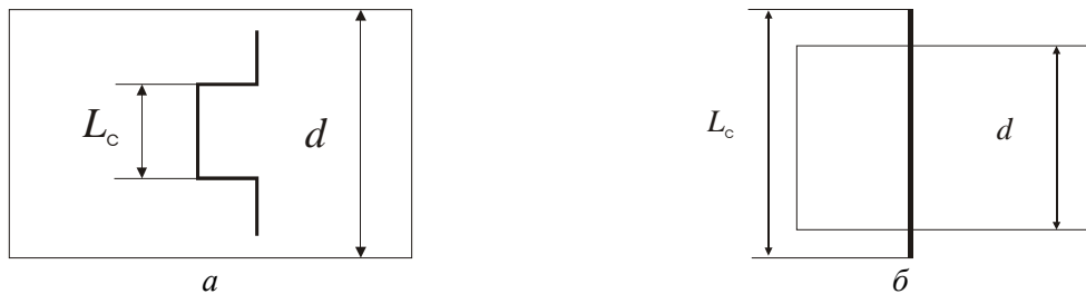
Рис. 1. Топология вихревой нити в перпендикулярном поле: а — при 3D пиннинге; б — при 2D пиннинге
