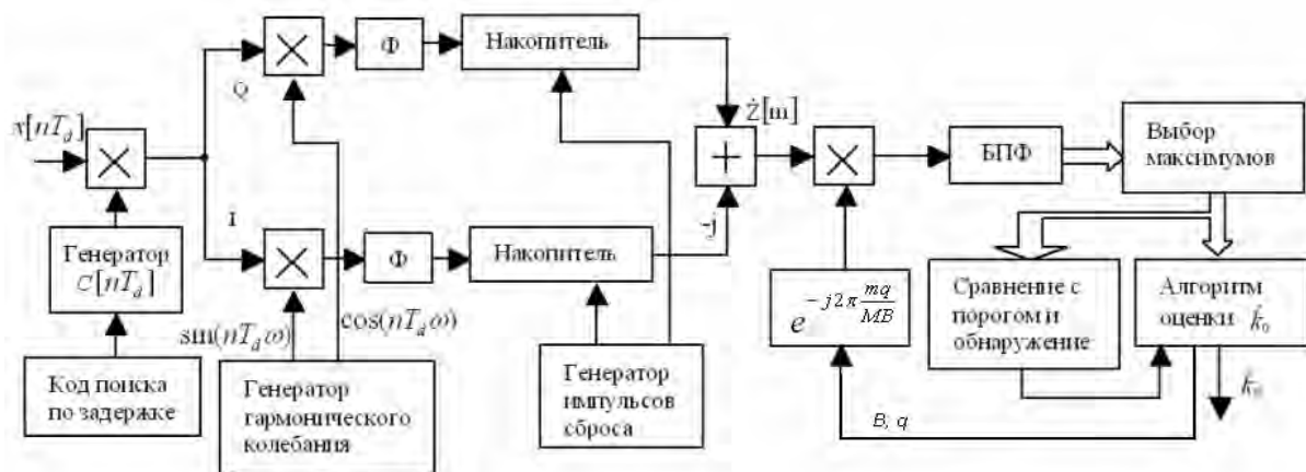
Рис. 1. Структурная схема последовательно-параллельного поиска и оценки параметров сложного сигнала
