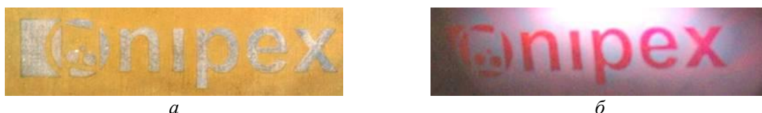
Рис. 7. Фотолюминесцентные изображения, полученные по маршруту с использованием операции травления ПОА в окнах маскирующего слоя: а — в дневном свете; б — красная фотолюминесценция при возбуждении ультрафиолетовым светом (380 нм)
