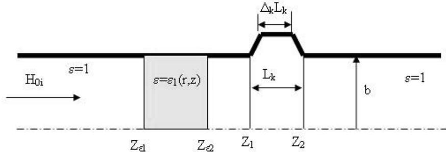
Рис. 1. Геометрия диэлектрического окна с компенсирующим рефлектором
