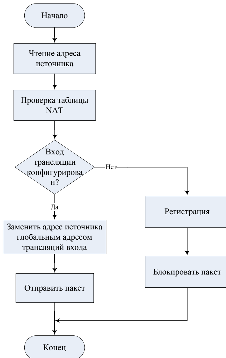
Рис. 2. Алгоритм трансляции внутреннего адреса источника статическим методом
