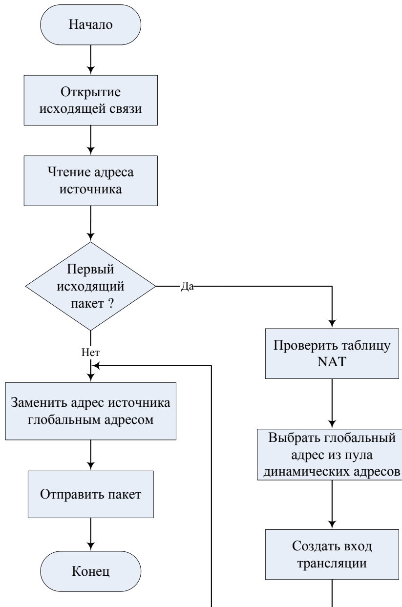
Рис. 3. Алгоритм трансляции внутреннего адреса источника динамическим методом
