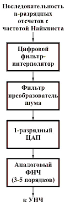
Рис. 4. Блок-схема алгоритма работы ЦАП с использованием сигма-дельта-модулятора
