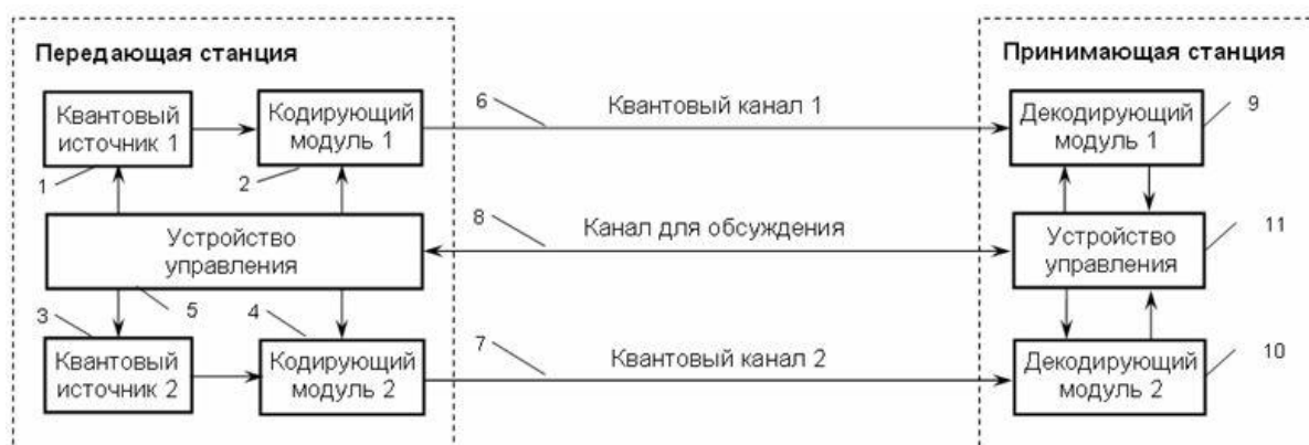
Рис. 1. Структурная схема двухканальной системы: 1 – первый квантовый источник — источник единичных фотонов; 2 – первый кодирующий модуль, осуществляющий кодирование последовательности битов будущего квантового ключа (например, задавая поляризацию фотонов) в одном из возможных базисов; 3 – второй квантовый источник; 4 – второй кодирующий модуль, осуществляющий кодирование последовательности битов будущего квантового ключа в базисах, противоположных по отношению к базисам, используемым для кодирования каждого бита кодирующим модулем 1; 5 – устройство управления, осуществляющее управление источниками фотонов, кодирующими модулями, выполняющее функции связи по каналу обсуждения, функции коррекции ошибок в ключевой последовательности и пр. (может быть реализовано в виде ЭВМ); 6, 7 – первый и второй квантовые каналы; 8 – канал для обсуждения (может быть реализован в виде любого канала связи, в зависимости от конкретной реализации установки: в том числе, например, для целей обсуждения могут использоваться и квантовые каналы 6, 7, а канал 8 может быть, в зависимости от конкретной реализации установки, как открытым, так и секретным); 9, 10 – декодирующие модули приемной станции, служащие для регистрации фотонов и декодирования ключевой последовательности; 11 – устройство управления принимающей станции.
