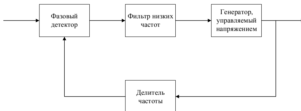
Рис. 2— Основная схема ФАПЧ
