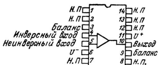
Рисунок В.4 – Корпус DIP
