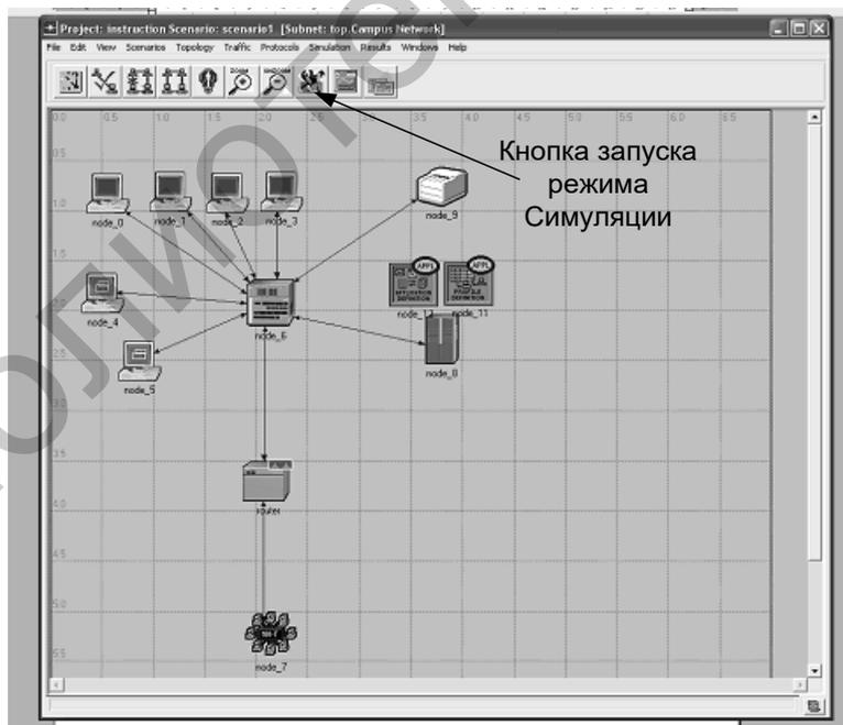
Рисунок 7.12 – Кнопка запуска режима симуляции
