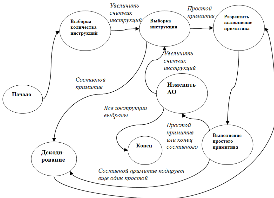
Рис. 5. Диаграмма состояний P-MBIST с оптимальным способом кодирования тестов
