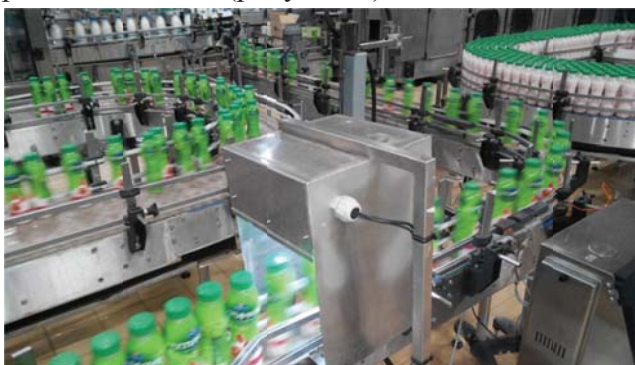
Рисунок 1 – Конвейер с блоком камеры
