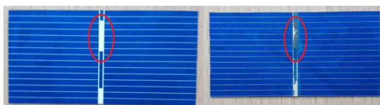
Рисунок 3 – Состояние контактной площадки после термических циклов
