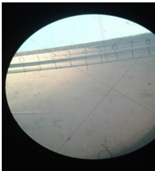
Рисунок 2 – Толщина слоя пористого кремния для образца КДБ-10 при времени анодирования 7,5 мин. Шаг линейки на рисунке равен 30 мкм
