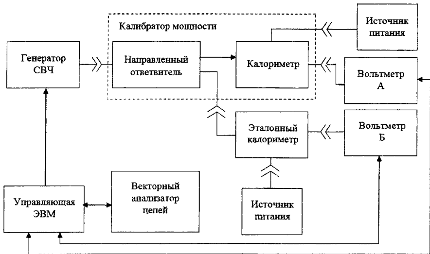
Рис. 1. Элементы эталонного комплекса
