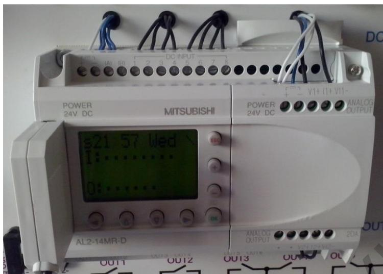
Рисунок 5.9 – Внешний вид микроконтроллера промышленного MITSUBISHI ELECTRIC "ALPHA-2"
