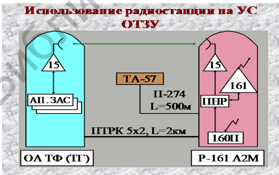
Рис. 4.2. Вариант использования радиостанции P-161A2M на узле связи ТЗУ
