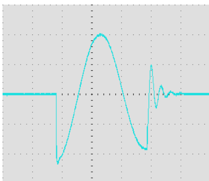
Рис. 3. Форма сигнала, наведенного импульсным магнитным полем.
