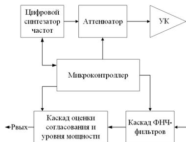
Рис. 1 – Структурная схема микропроцессорной системы управления
