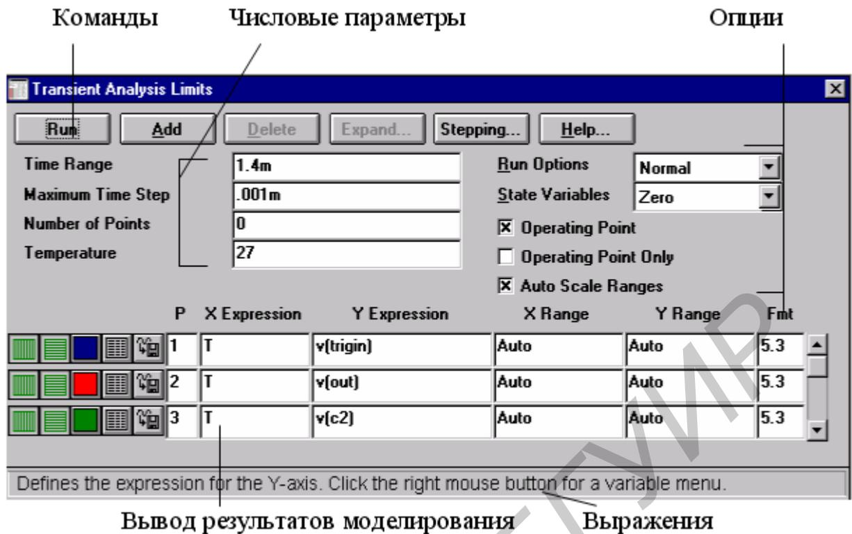
Рисунок 3.1 – Задание параметров расчета переходных процессов
