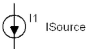
Рисунок 5.3 – УГО источника постоянного тока
