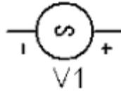
Рисунок 5.11 – УГО независимого источника напряжения
