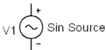
Рисунок 5.5 – УГО источника синусоидального напряжения
