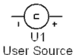
Рисунок 5.9 – УГО источника напряжения, задаваемого пользователем
