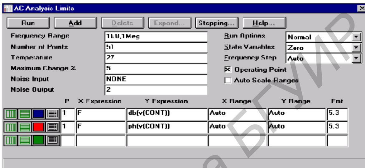
Рисунок 3.2 – Задание параметров расчета в режиме AC
