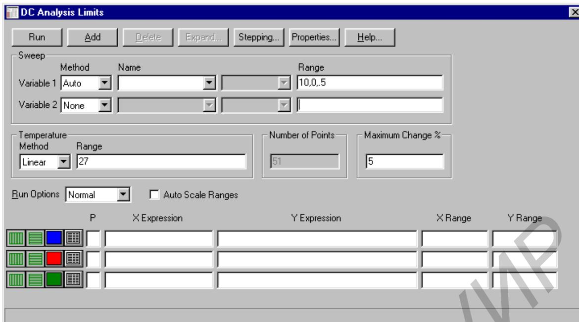
Рисунок 3.3 – Задание параметров расчета в режиме DC
