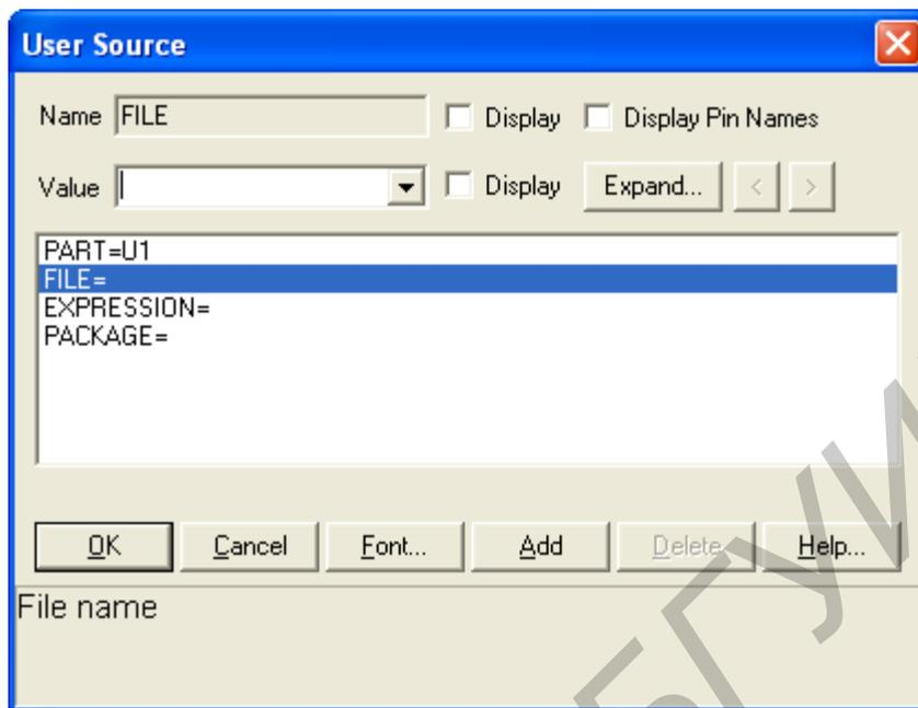
Рисунок 5.10 – Окно атрибутов источника напряжения, задаваемого пользователем
