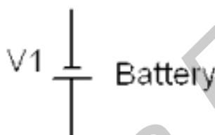
Рисунок 5.1 – УГО источника постоянного напряжения
