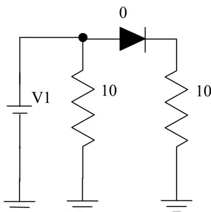
Рисунок 6.4 - Схема диодного ограничителя напряжения
