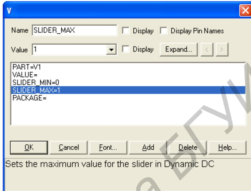
Рисунок 5.12 – Окно атрибутов независимого источника напряжения
