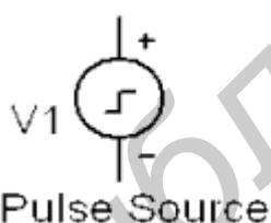
Рисунок 5.7 – УГО источника импульсного напряжения
