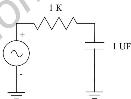
Рисунок 6.6 – Схема фильтра нижних частот первого порядка
