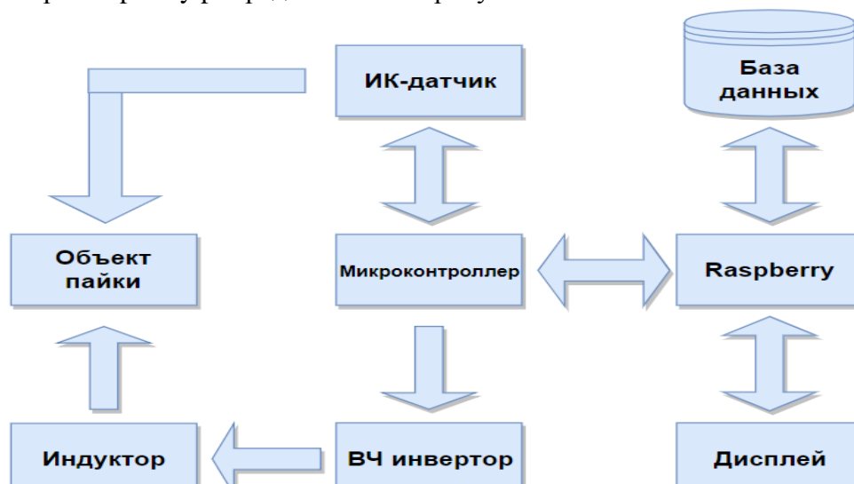
Рисунок 3 – Схема установки контроля параметров индукционной пайки
