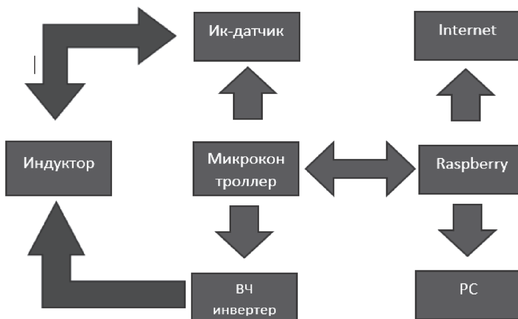
Рис.4. Схема установки контроля параметров индукционной пайки.
