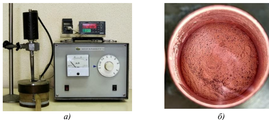
Рис.2. Устройство модификации составов припоев (а) и расплав припоя с УНТ в тигле (б)
