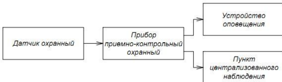
Рисунок 1 – Структурная схема системы охранной сигнализации
