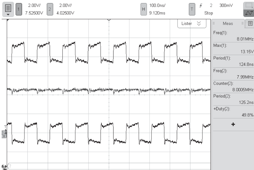
Рис. 3. Осциллограмма выходного сигнала с нагрузкой на кабель
