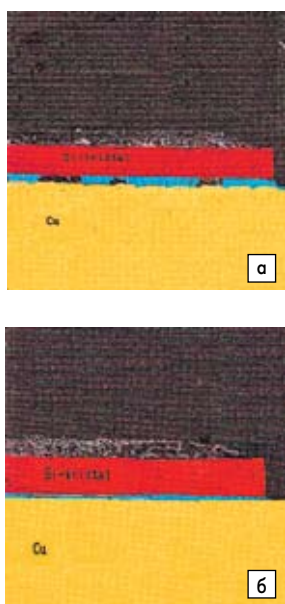
Рис. 15. Внешний вид паяного соединения под кристаллом: а) для пассивного процесса пайки; б) для активного процесса пайки
