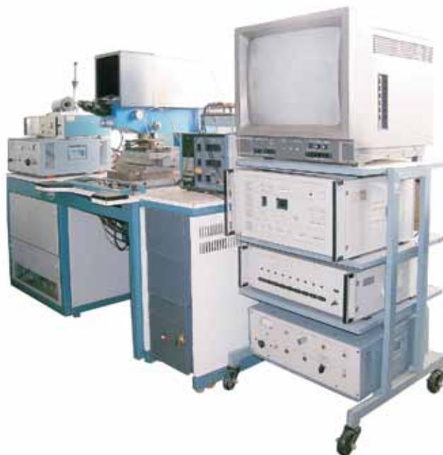
**Рис.1. Лазерный фотоакустический комплекс неразрушающего контроля**
