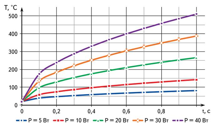
Рис. 8. Зависимость температуры поверхности вывода от времени воздействия лазерного излучения и его мощности
