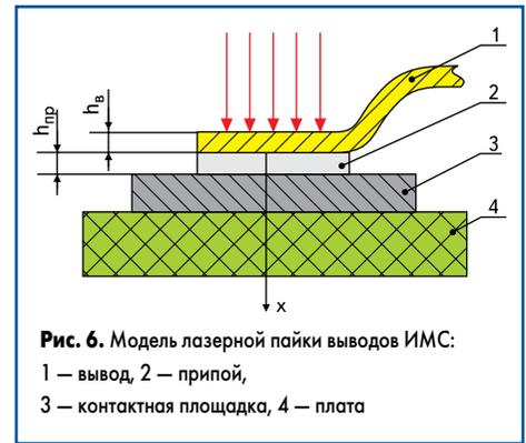
Рис. 6. Модель лазерной пайки выводов ИМС:
