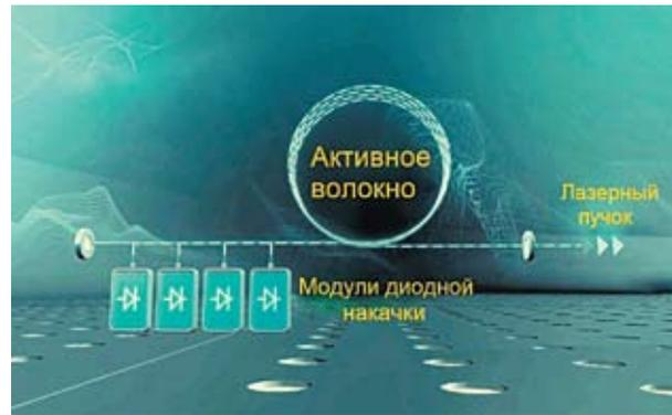
Рис. 2. Схема волоконного лазера с диодной накачкой
