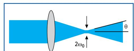
Рис. 4. Определение BPP (произведение диаметра пучка в перетяжке ( $2\omega_0$ ) на половину угла расходимости ( $\theta$ ))
