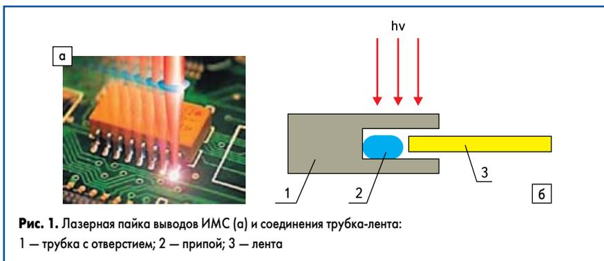
**Рис. 1.** Лазерная пайка выводов ИМС (а) и соединения трубка-лента:
