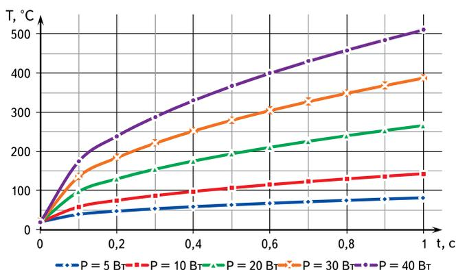
Рис. 7. Зависимость температуры наружной поверхности вывода от времени и мощности лазера
