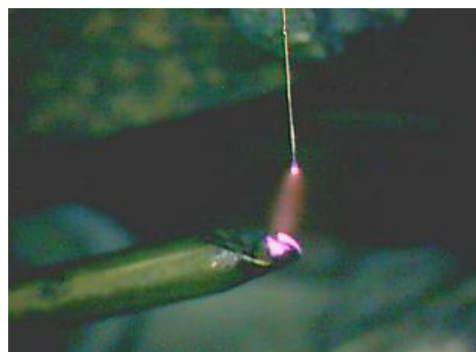
Рис. 3. Форма искрового разряда на кончике медной проволоки диаметром 50 мкм при отрицательной полярности на электроде
