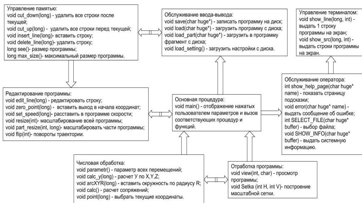
Рисунок 3. Схема автоматизированной подготовки программ управления элементами технологического модуля лазерного комплекса
