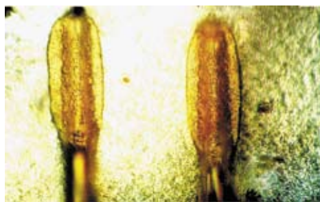
Рис. 15. Внешний вид сварных соединений золотой проволокой диаметром 20 мкм методом «клин-клин»
