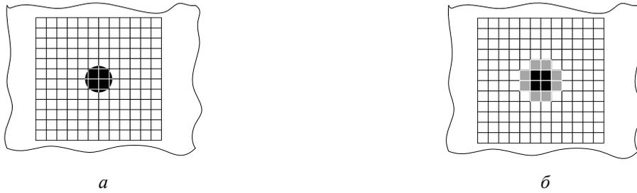
Рис. 2. Дискретизированное по пространственным координатам изображение (а) и пространственное распределение числа накопленных фотоэлектронов в дискретах ФПЗС-матрицы (б)
