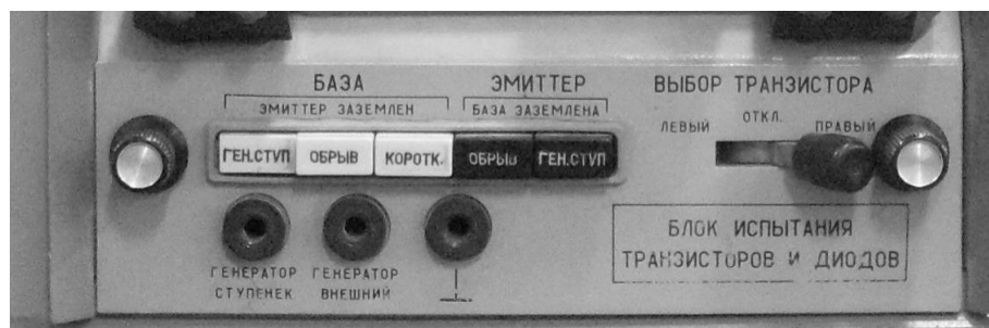
Рис. 3.3. Переключатели на нижней панели прибора
