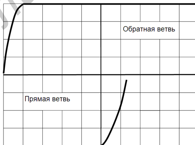
Рис. 3.5. ВАХ диода (стабилитрона)
