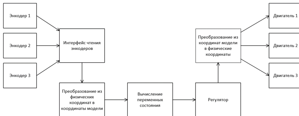
Рис. 3 – Пример системы управления
