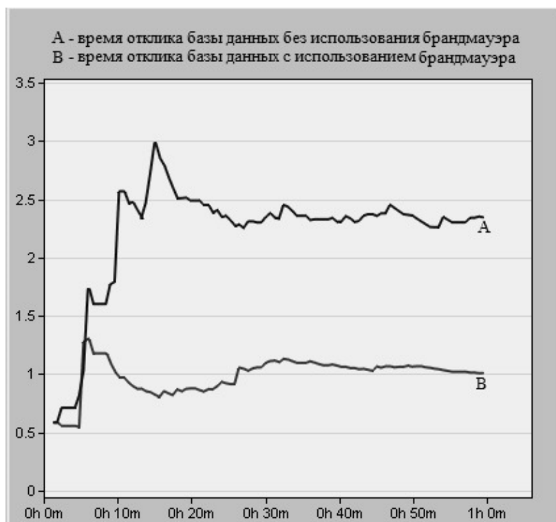
Рис. 4. Графики сравнения отклика баз данных без использования и с использованием брандмауэра
