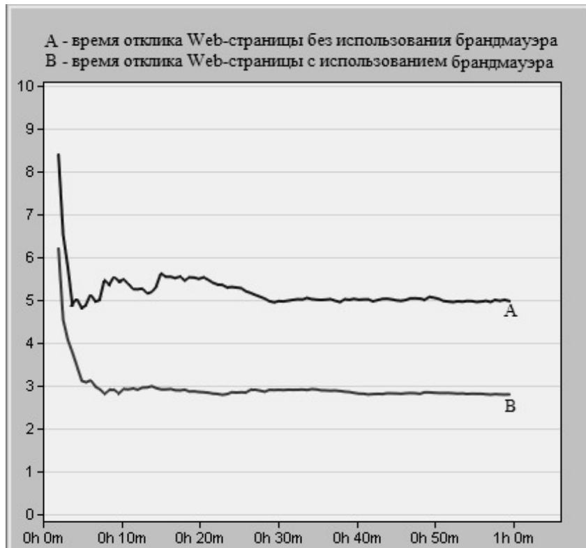
Рис. 5. Графики сравнения отклика Web-страниц без использования и с использованием брандмауэра
