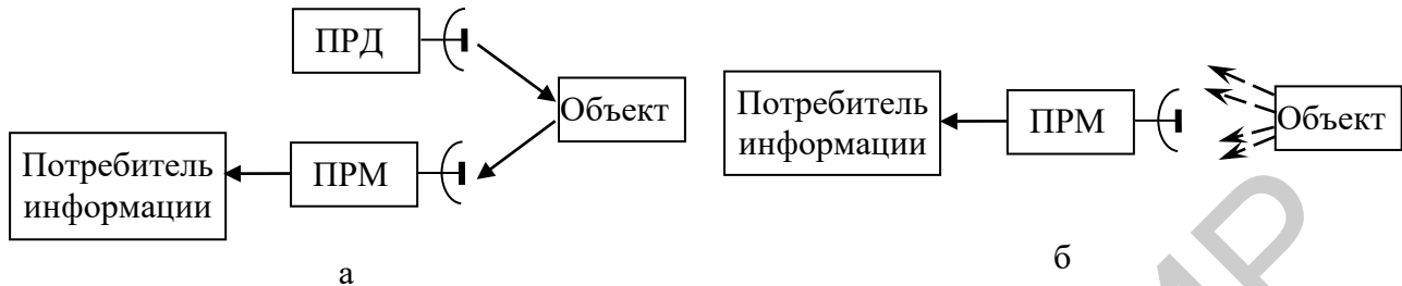
Рис. 1.2. Принцип реализации РТС извлечения информации
