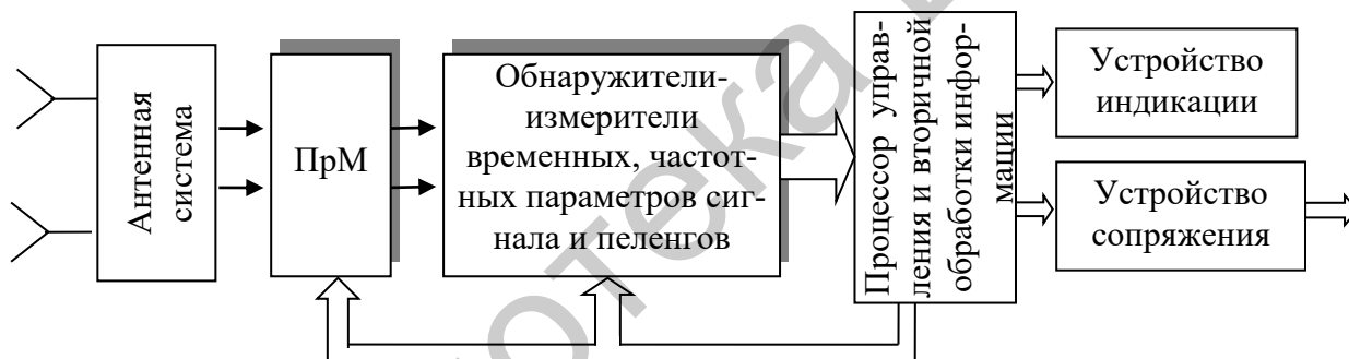
Рис. 3.1. Структурная схема средства РРТР
