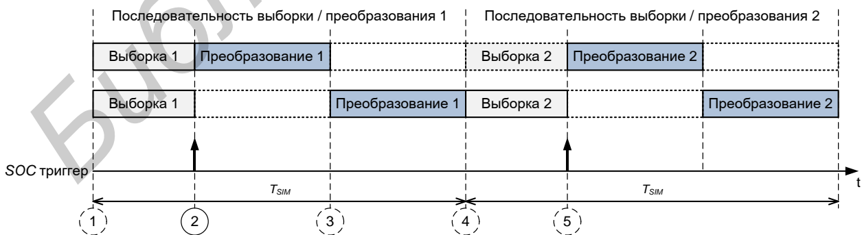
Рис. 2.11. Фазы преобразования АЦП
