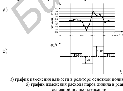
Рис. 1. Графики изменения выходной величины при внесении возмущений заданной амплитуды
