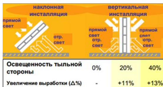
Рисунок 1 – Варианты инсталляции двусторонних модулей Sanyo и увеличение годовой выработки электроэнергии при различной освещенности тыльной стороны
