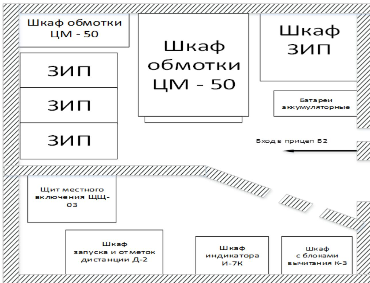
Рис. 6.2. Схема расположения аппаратуры прицепа В2
